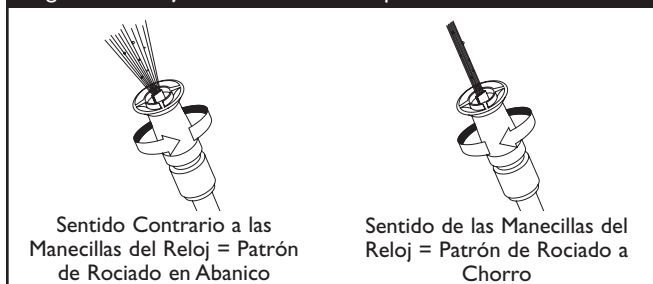
Figura 28 — Ajustar el Patrón de Aspersión
